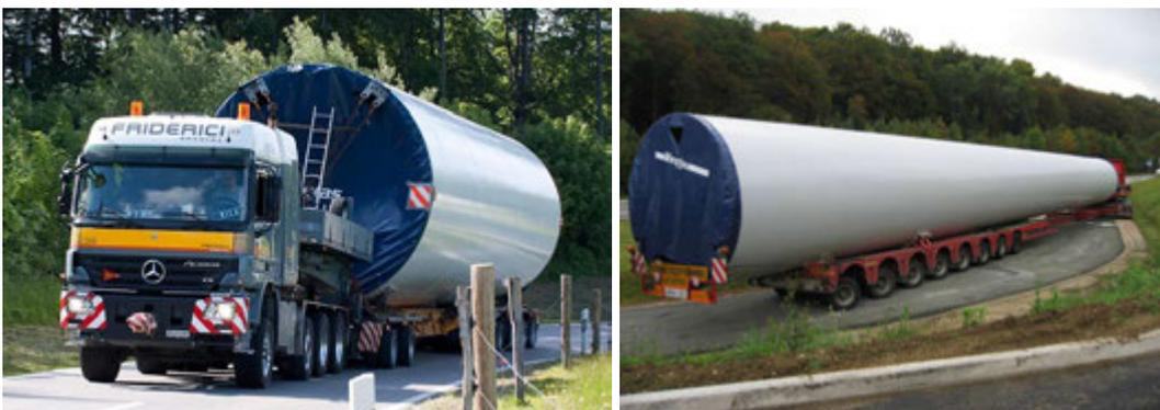
*Figure 30: convoi de transports des organes d'éoliennes.*
